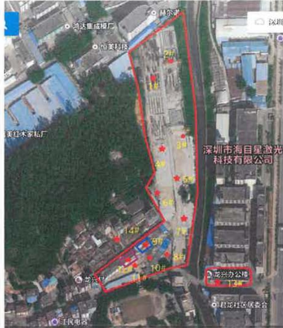
图 20 土壤和地下水布点图
